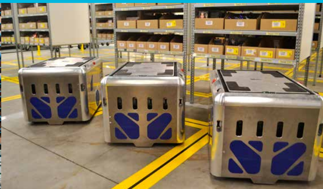
Exemple de robots développés par Scallog se déplaçant le long des lignes au sol pour apporter les étagères à l'opérateur chargé du picking
