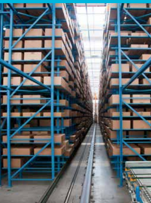
Tour de stockage et transstockeur
