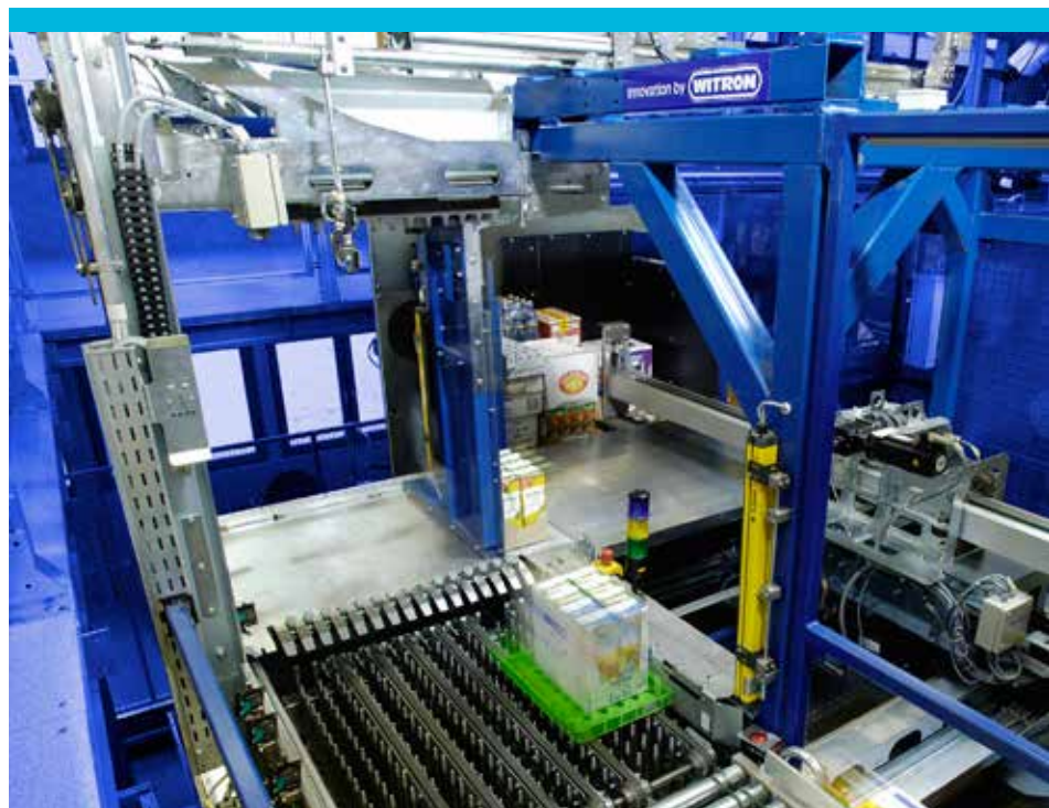
Système de palettisation hétérogène automatisée avec bras pousseur développé par Witron
