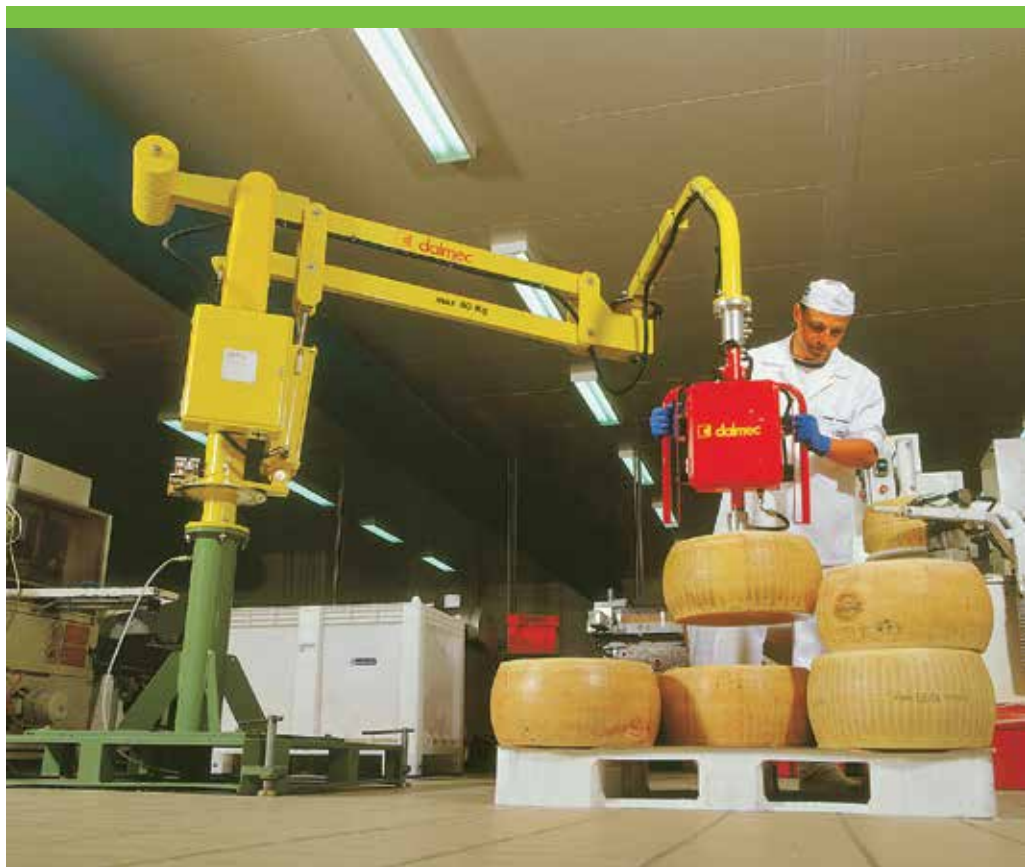
Utilisation de cobot Dalmec pour l'aide à la palettisation
