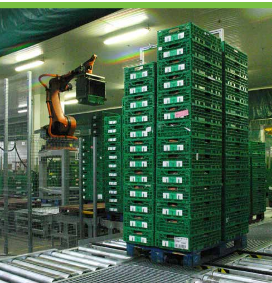
Bras robotisé manipulant des caisses plastiques de même format chez Système U Ouest
