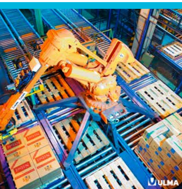
Système de palettisation hétérogène automatisée avec bras robotisé développé par Ulma
