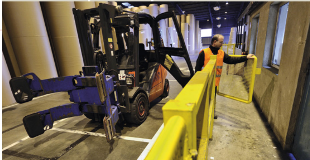
Figure 3. Chemin piétonnier sécurisé © Gaël Kerbaol / INRS
