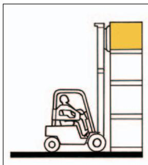
Amener les bras de fourches à l'horizontale. Déposer lentement la charge sur l'emplacement de gerbage. Dégager la fourche en l'abaissant légèrement ou en se servant au besoin de l'inclinaison avant prévue par le constructeur.
