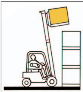
Soulever la charge. Incliner le mât en arrière et après avoir regardé derrière, reculer.
