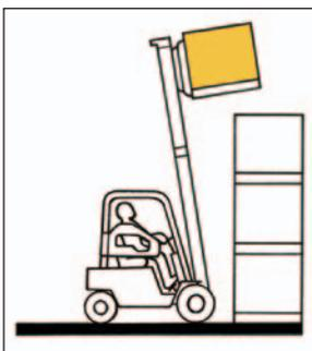
Avancer lentement le chariot jusqu'à ce que la charge se trouve au-dessus de l'emplacement du gerbage. Freiner l'appareil.
